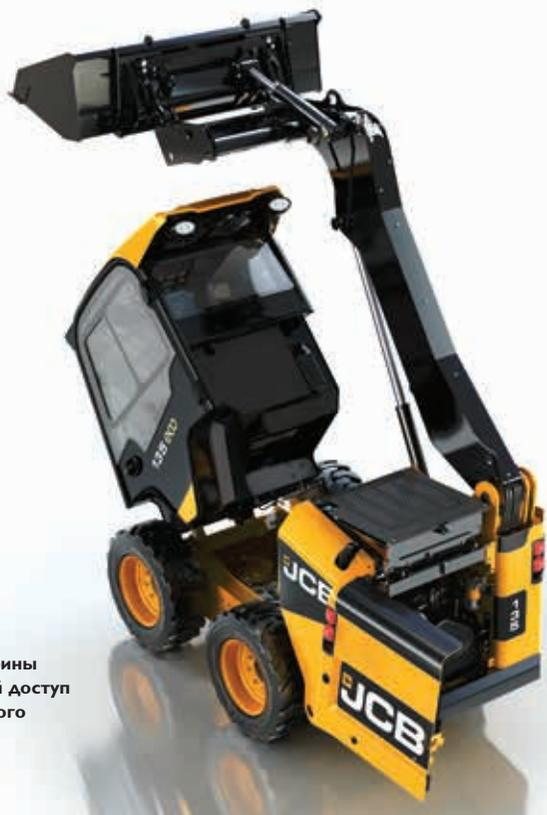
Откидная конструкция кабины JCB обеспечивает удобный доступ для проведения технического обслуживания.
