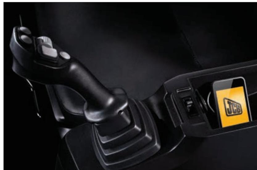
Опциональный многофункциональный джойстик позволяет оператору управлять более широким диапазоном гидравлического навесного оборудования. В левом подлокотнике также имеется отсек для хранения личных вещей.
